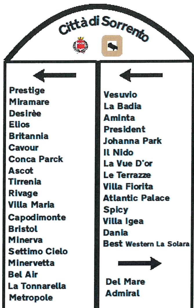
Struttura come foto in ferro zincato a caldo e verniciato a polvere di colore nero, diametro 8 0mm. Alla sommità della struttura deve essere presente una sezione ad arco di adeguata consistenza riportante logo e denominazione Ente, Totale altezza struttura 4,30
