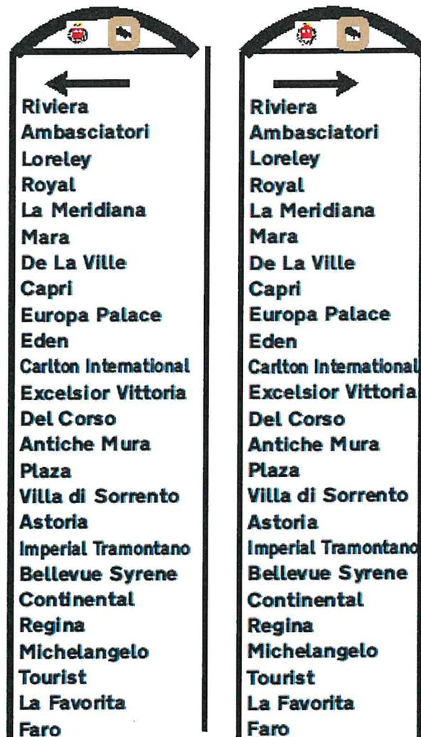
Struttura come foto in ferro zincato a caldo e verniciato a polvere di colore nero, diametro 8 0mm. Alla sommità della struttura deve essere presente una sezione ad arco di adeguata consistenza riportante logo e denominazione Ente, Totale altezza struttura 4,50
