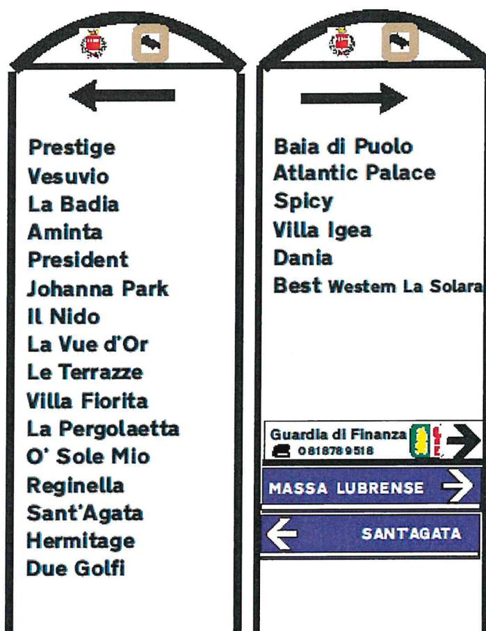
Struttura come foto in ferro zincato a caldo e verniciato a polvere di colore nero, diametro 8 0mm. Alla sommità della struttura deve essere presente una sezione ad arco di adeguata consistenza riportante logo e denominazione Ente, Totale altezza struttura 480
