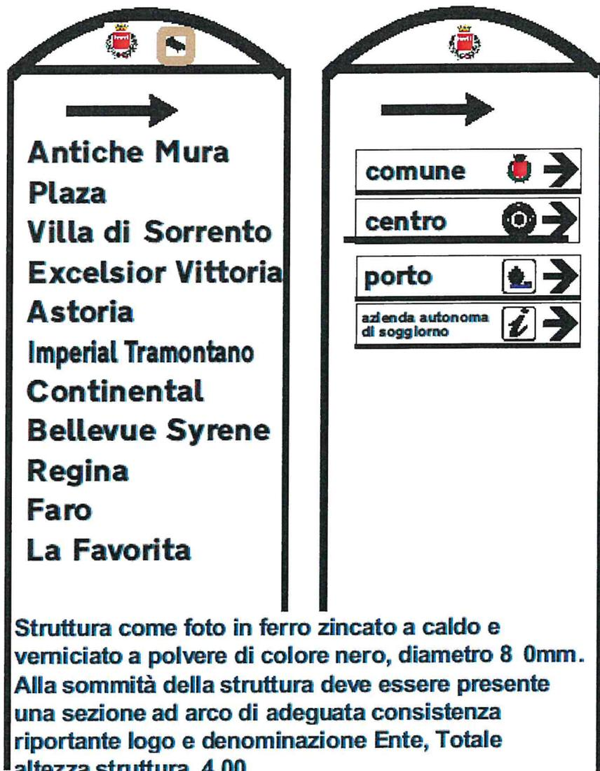
Struttura come foto in ferro zincato a caldo e verniciato a polvere di colore nero, diametro 8 0mm. Alla sommità della struttura deve essere presente una sezione ad arco di adeguata consistenza riportante logo e denominazione Ente, Totale altezza struttura 4,00
