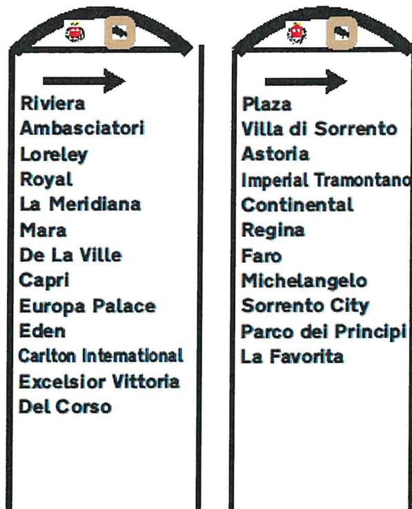
Struttura come foto in ferro zincato a caldo e verniciato a polvere di colore nero, diametro 8 0mm. Alla sommità della struttura deve essere presente una sezione ad arco di adeguata consistenza riportante logo e denominazione Ente, Totale altezza struttura 4,00
