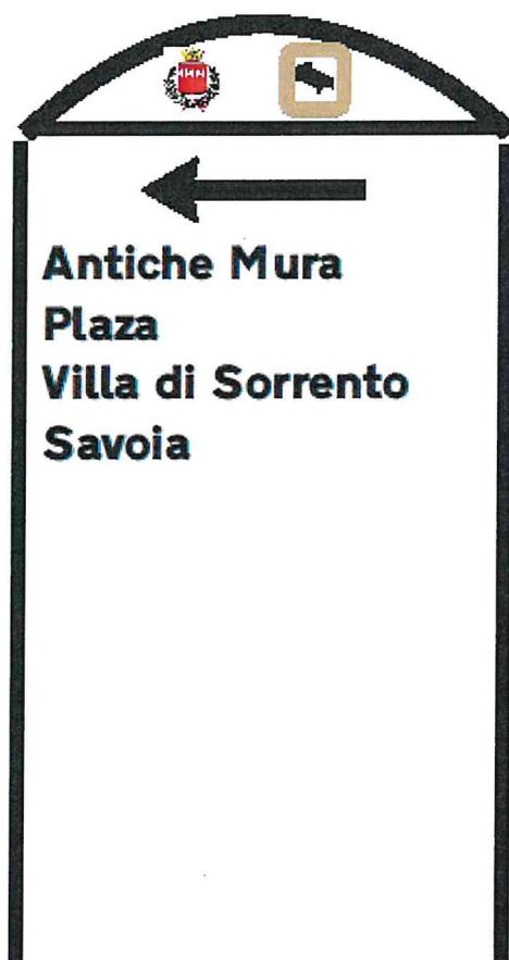
Struttura come foto in ferro zincato a caldo e verniciato a polvere di colore nero, diametro 8 0mm. Alla sommità della struttura deve essere presente una sezione ad arco di adeguata consistenza riportante logo e denominazione Ente, Totale altezza struttura 3,50
