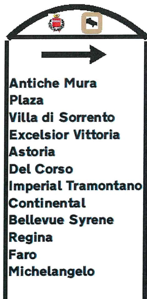
Struttura come foto in ferro zincato a caldo e verniciato a polvere di colore nero, diametro 8 0mm. Alla sommità della struttura deve essere presente una sezione ad arco di adeguata consistenza riportante logo e denominazione Ente, Totale altezza struttura 4,30
