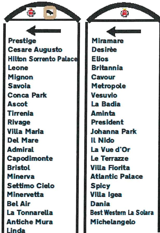
**Struttura come foto in ferro zincato a caldo e verniciato a polvere di colore nero, diametro 80mm. Alla sommità della struttura deve essere presente una sezione ad arco di adeguata consistenza riportante logo e denominazione Ente, Totale altezza struttura 4,50**
