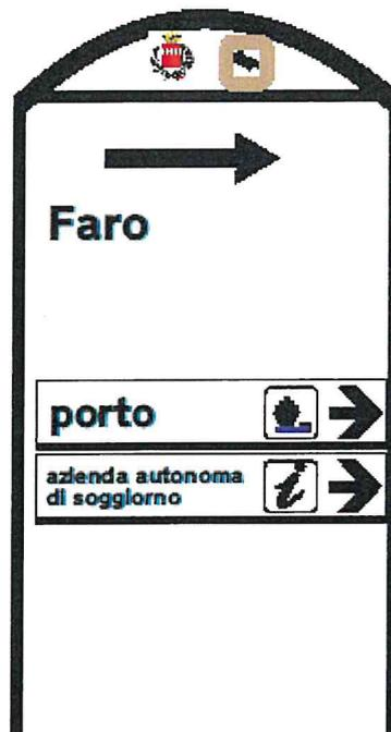
Struttura come foto in ferro zincato a caldo e verniciato a polvere di colore nero, diametro 80 mm. Alla sommità della struttura deve essere presente una sezione ad arco di adeguata consistenza riportante logo e denominazione Ente, Totale altezza struttura 2,00
